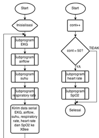
Gambar 3.2 Flow chart program utama (kiri) dan flow chart program interrupt (kanan) pada Arduino Uno
