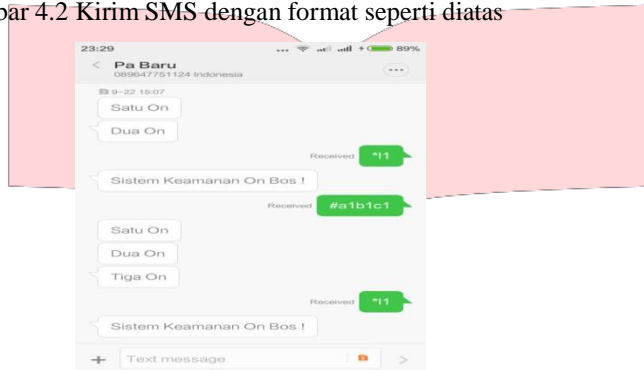
Gambar 4.3 Konfirmasi dari arduino dikirm melalui modul sim 900
