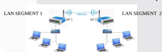
Gambar 2.1 WDS dengan Mode Bridge Point to Point
