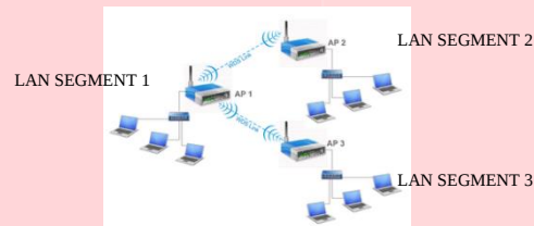
Gambar 2.2 WDS dengan Mode Bridge Point to Multipoint
