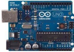
**Gambar 2.3** Board arduino uno
