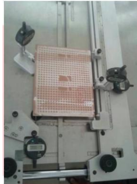
Gambar I.1 Pengujian Kesikuan Eksisting (BBK, 2015)
