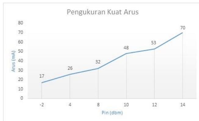
Gambar 4. 4 Grafik pengukuran kuat arus pada rangkaian
