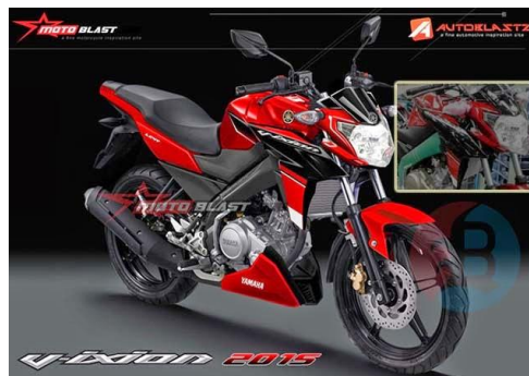
Gambar 1. 4 Penambahan cover engine menutup ruang kosong yang ada
