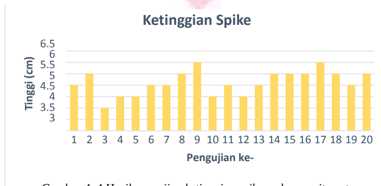
Gambar 4.4 Hasil pengujian ketinggian spike pada security gate
