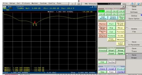
Gambar 4.1 Hasil pengukuran return loss input
