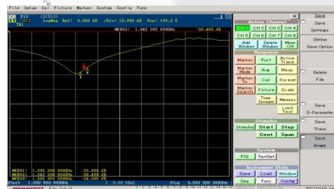
Gambar 4.5 Hasil Pengukuran isolation
