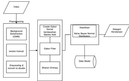
Gambar 3.2. Alur Perancangan Sistem Uji Klasifikasi Kendaraan
