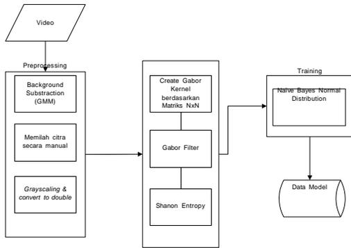
Gambar 3.1. Alur Perancangan Sistem Latih Klasifikasi Kendaraan
