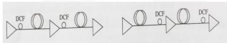
Gambar 2.3 Skema penyisipan DCF pada link optik [13]
