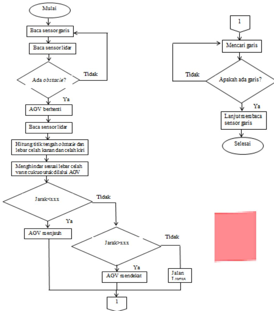
Gambar 3. Diagram Alir Umum Pergerakan Collision Avoidance
