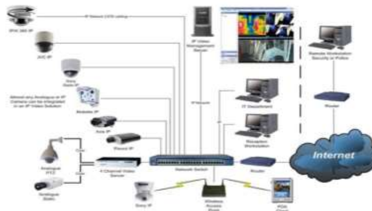
Gambar 2.1 Hybrid CCTV, penggunaan analog camera dan IP camera secara bersamaan
