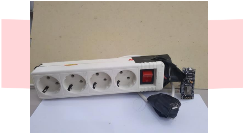
Gambar 12: Terminal Listrik Pintar
