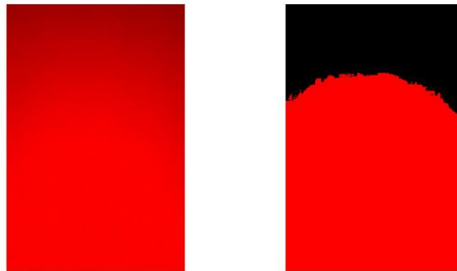
Gambar 3. Frame sebelum thresholding (kiri) dan frame setelah thresholding (kanan)
