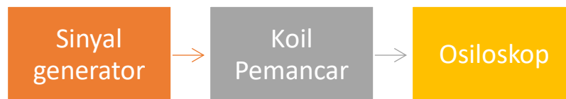
Gambar 4.7 Blok Diagram Output Pemancar Saat Terhubung Koil.
