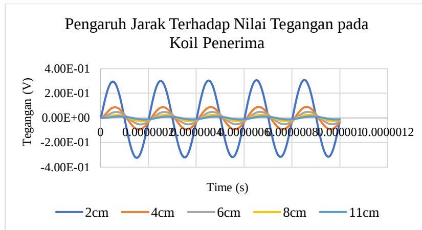
Gambar 4.4 Gelombang nilai tegangan penerima terhadap perubahan jarak.
