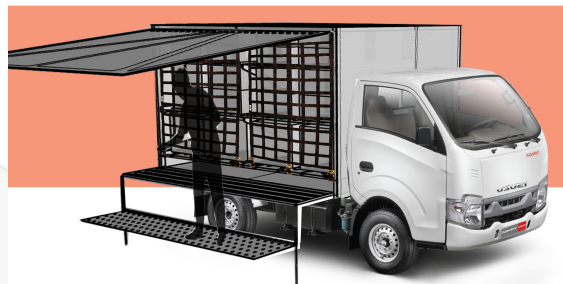
Gambar 2.19 Operasional mengaitkan webbing mesh
