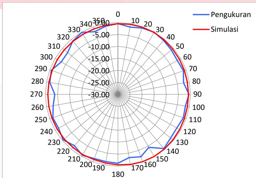
Gambar 9 Pola radiasi azimuth 0° Frekuensi 10 GHz
