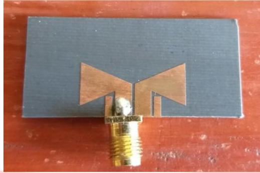
Gambar 8 Realisasi Antena Microstrip Bowtie
