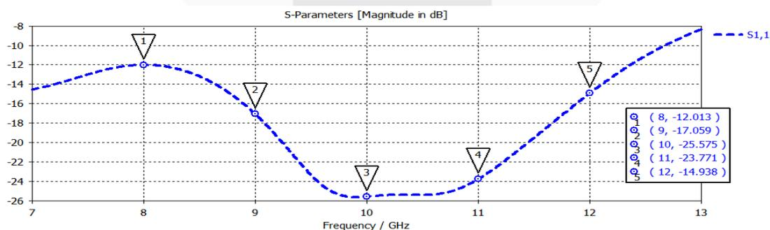
**Gambar 5** Nilai Return Loss Setelah Optimasi
