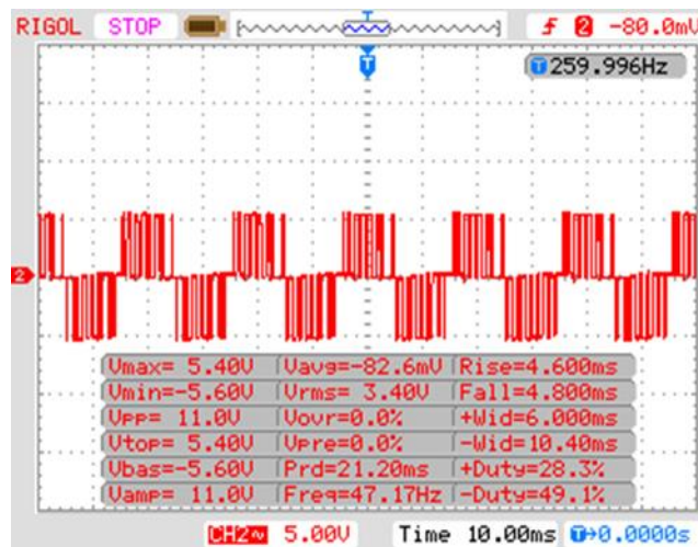
Gambar 7. Tegangan keluaran inverter dengan beban 15k\Omega ( m_f = 8 );( m_a = 0,8 )
