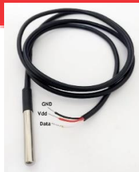
Gambar 2.1 Bentuk fisik sensor suhu DS18B20 (Sumber: Arduino DS18B20 temperature sensor)
