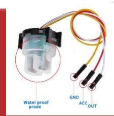
Gambar 2.3 Bentuk fisik sensor kekeruhan air (Sumber: http://followtheart.info/kareff-Mon_5_19.html )
