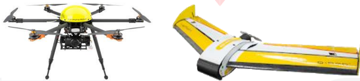
Gambar 2.1 Klasifikasi drone berdasarkan bentuk sayap
