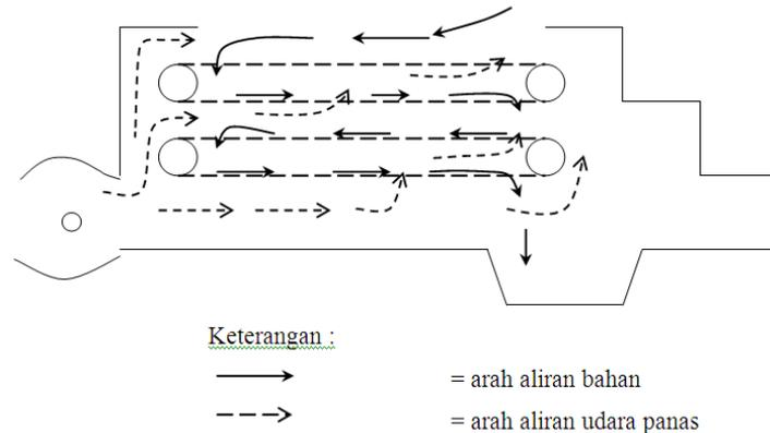
Gambar I. 2 Aliran Bahan dan Aliran Udara Panas (Maharani, 2012)
