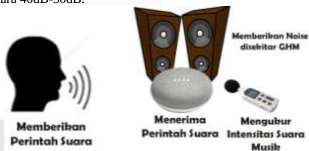
Gambar 4. 7 Skema Pengujian Terhadap Noise
