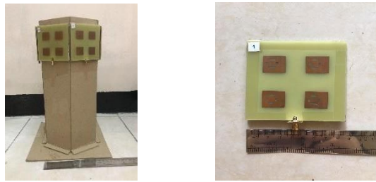
Gambar 7. Hasil realisasi antenna susun 2 \times 2 rectangular patch 3,5 GHz empat sektor.
