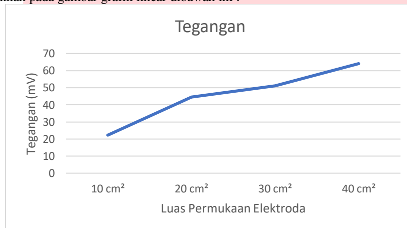
Gambar 4.9 Hasil pengukuran tegangan terhadap luas permukaan elektroda terdistribusi
