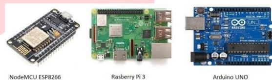
Gambar 2.1 Perbandingan Mikrokontroller
