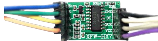
Gambar 2. 4 Bentuk fisik Modul HX711
