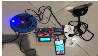
Gambar 8. Kondisi ketika wireless smart energy meter disambungkan dengan 1 perangkat(setrika)
