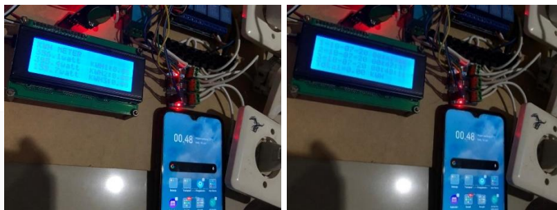
Gambar 13. Tampilan LCD yang memberikan informasi tentang daya dan waktu ketiga perangkat disambungkan
