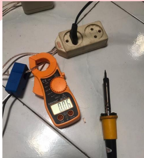
Gambar 4.8 Pembacaan Nilai Pada Clamp Multimeter Dengan Alat Solder
