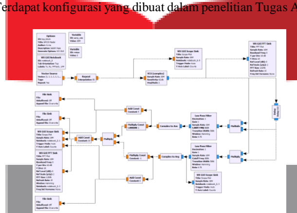
Gambar 3.3 Konfigurasi sistem radar SFCW untuk mendeteksi selisih fasa terhadap getaran.
