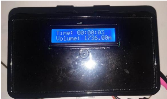
Gambar 4. 14 Sistem arduino keadaan hidup
