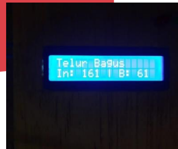
Gambar 4.10 Pengujian Sensor LDR Telur 1
