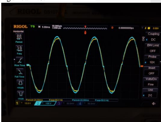
Gambar 4.8 Kondisi Inverter leading Terhadap PLN
