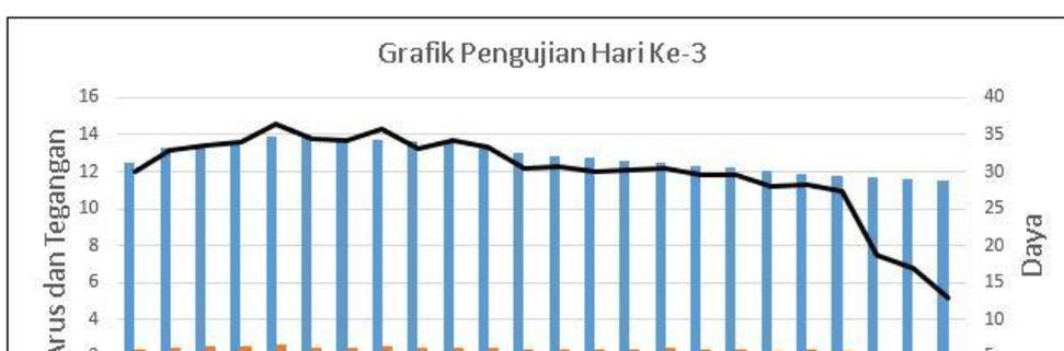
Gambar 4.3 menunjukkan grafik dari pengujian sistem pada hari ke-3. Pada grafik dapat dilihat nilai daya turun pada pukul 02.00 dan 05.00 dikarenakan beban prioritas 2 dan 3 mati.
