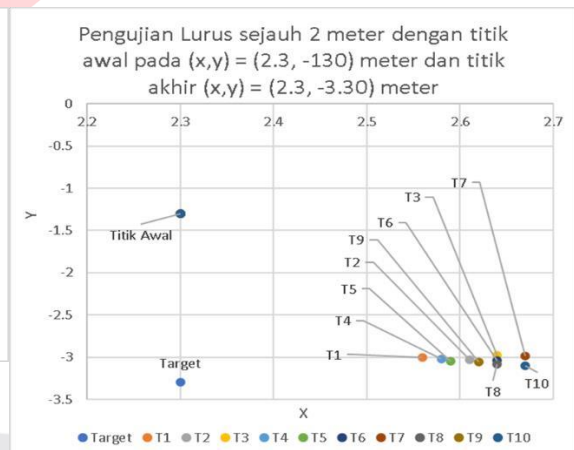
Gambar 4.12. Plot Grafik Pose Titik Awal dan Titik Akhir Kursi Roda Setiap Pengujian, titik awal (2.3, -1.3) meter.
