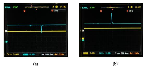
Gambar 4.15 Hasil Pengukuran Beban di 110 Ω Menjadi (a) 100 Ω (b) 120 Ω (Note : x = 500 ms/div dan y = 5V/div ,
