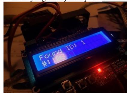
GAMBAR 4. 4 Hasil Pengujian Mendeteksi kembali ID Yang Terdaftar
