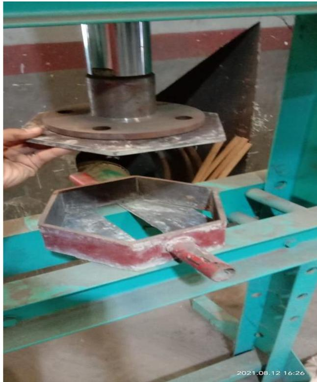
Gambar 3 Cetakan Paving Block
