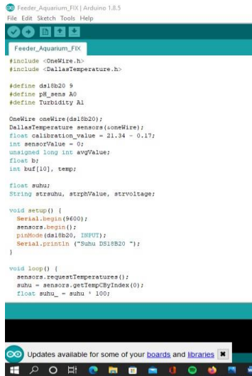
Gambar 3.5 merupakan tampilan Arduino IDE. Terdapat beberapa menu yang menjadi fitur pada software ini. Software Arduino IDE ini terdapat message box yang dapat menampilkan status selama melakukan pemrograman, seperti pesan error, compile, dan upload program. Pada ujung kanan atas terdapat simbol cermin pencarian. Simbol tersebut merupakan serial monitor yang berfungsi untuk menampilkan data yang telah di proses.
