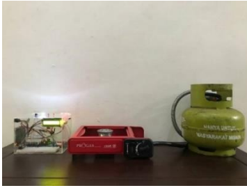
GAMBAR 3. 1 Pengujian Sensor Gas MQ-2
