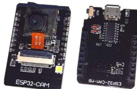
**Gambar 2. 3** ESP32 CAM dan ESP32 CAM UART
