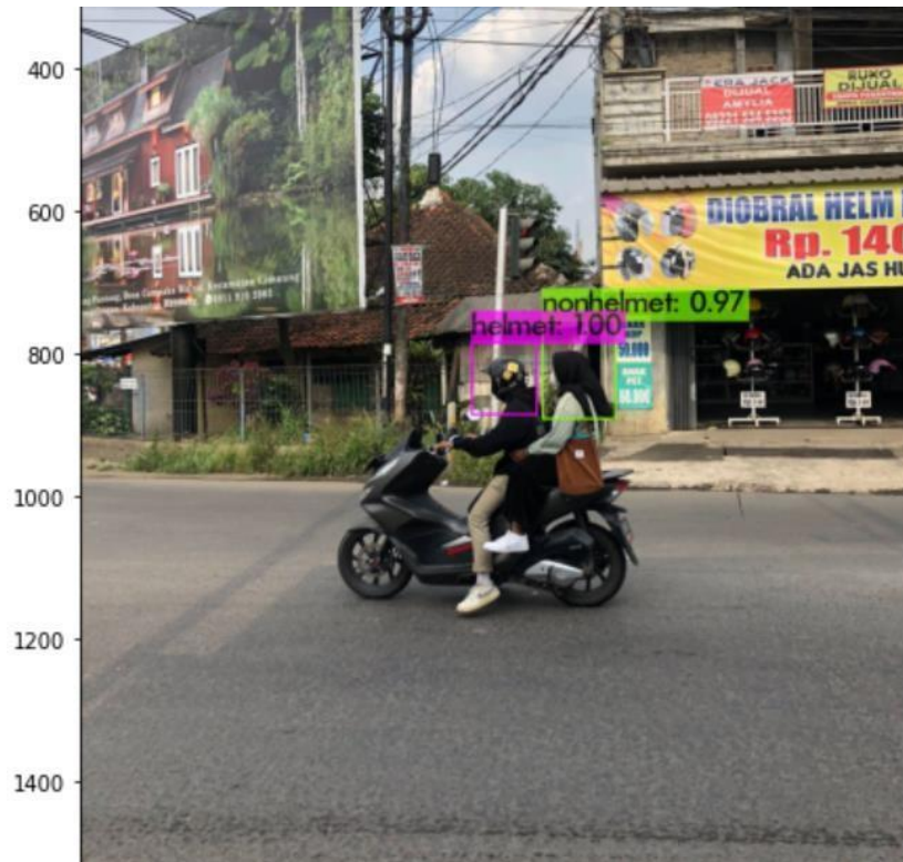
GAMBAR 21 CONTOH HASIL DETEKSI OBJEK MENGGUNAKAN MODEL YOLO TINY3
