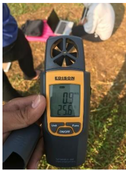
Gambar 9 Nilai Kecepatan Maksimum Pada Anemometer
