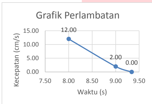
Gambar IV-5 Grafik Perlambatan Pengujian Kecepatan Aman
