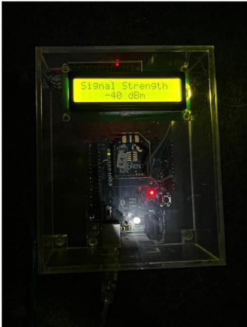
Pengujian *Liquid Crystal Display* (LCD) dan Xbee dengan cara menghubungkan LCD pada Xbee dan hubungkan pada pin Arduino. Setelah selesai menghubungkan, membuat kode program untuk di upload ke Arduino. Pada Gambar 4.4 menunjukkan bahwa LCD sudah menampilkan karakter. Hal ini menunjukkan bahwa LCD dapat berfungsi dengan baik. Pengujian dilanjutkan dengan membuat kode program untuk menampilkan Sinyal RSSI, sehingga LCD dapat menampilkan hasil sinyal RSSI.
