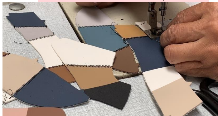
Gambar 8: Proses menjahit dengan teknik zig-zag Sumber: Domuentasi Penulis, 2022
