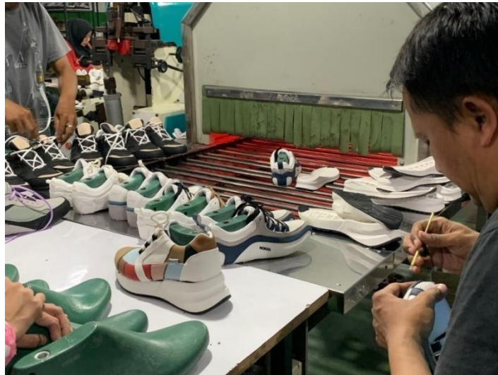
Gambar 10: Proses pengeleman sol dan upper proses pemanasan Sumber: Dokumentasi Penulis, 2022
