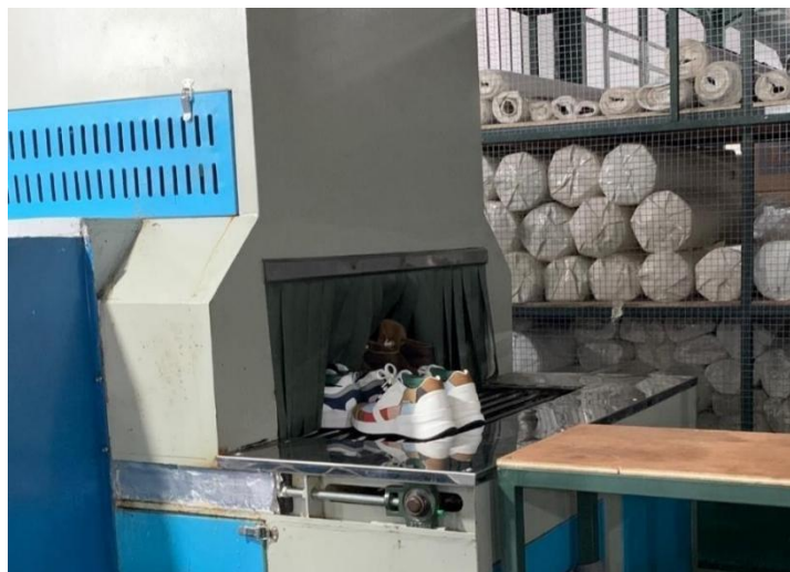
Gambar 11: Proses Pendinginan Sumber: Dokumentasi Penulis, 2022
