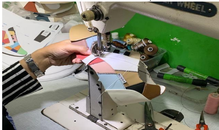
Gambar 9: Proses menjahit upper sepatu Sumber: Dokumentasi Penulis, 2022
