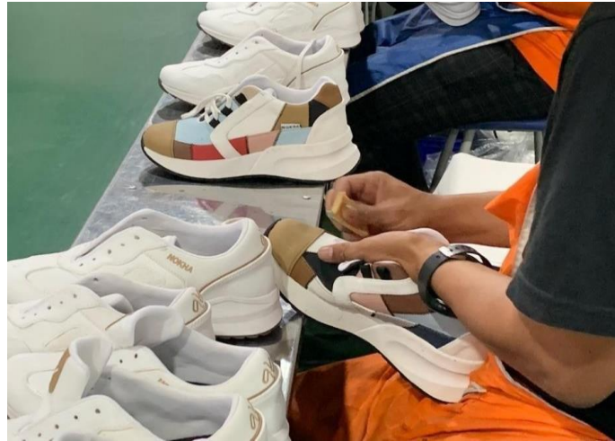
Gambar 12: Proses terakhir memasang tali sepatu Sumber: Dokumentasi Penulis, 2022
