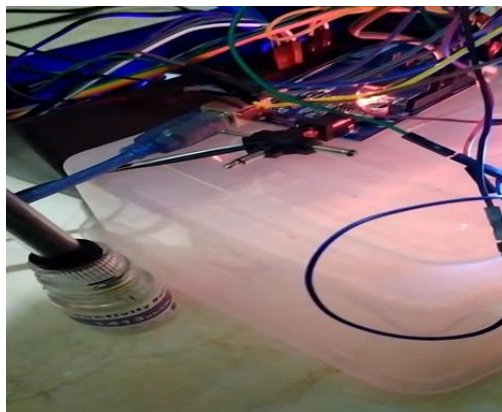
Gambar Kalibrasi EC
