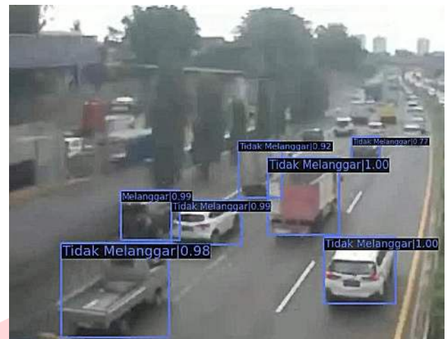
Gambar 18. Hasil deteksi pelanggaran menggunakan Cascade R-CNN
