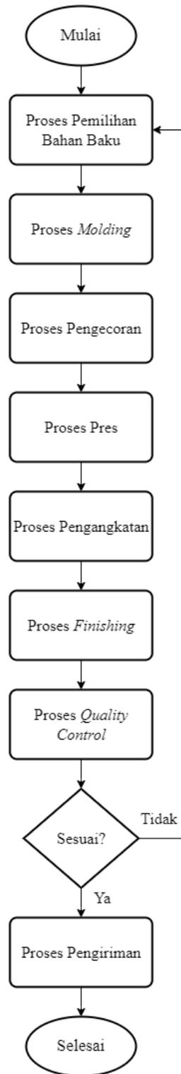
Gambar I. 2 *Flow* Proses Produksi PT XYZ
