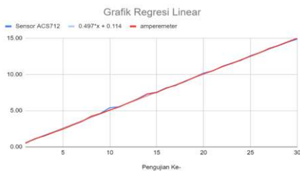
GAMBAR 10. Grafik Regresi Linear Kalibrasi Sensor ACS712 30A
